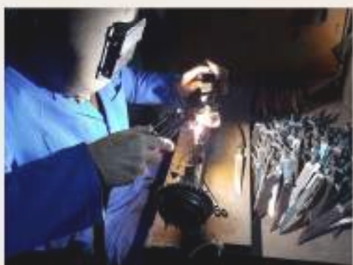
Soudure d'une lame forgée sur un manche monocoque
